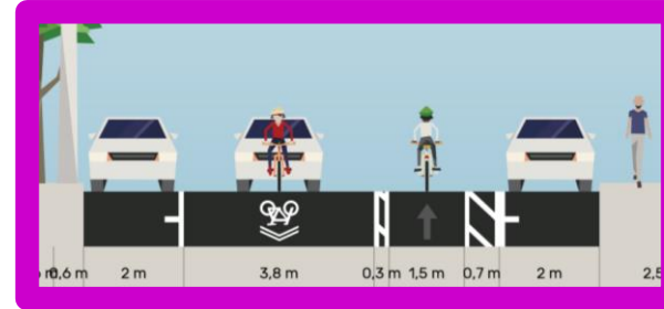
Bande cyclable en contresens de la circulation
