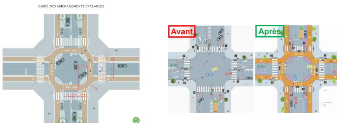
Carrefour protégé à la hollandaise selon le Guide des aménagements cyclables de Paris en Selle (2019)
